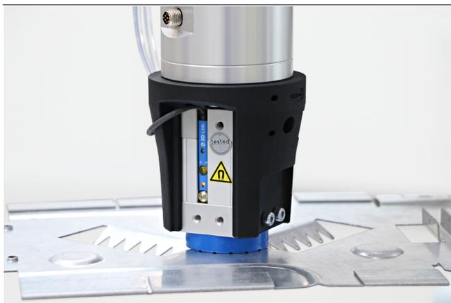
Garra magnética SGM-SV para la manipulación de chapa perforada
